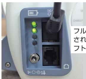
写真2- リフトの電源が入ると、表示灯が緑に点灯します。
