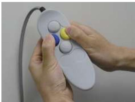
ハンドスイッチの青と黄の方向ボタンを同時に3～5秒長押しすることでオートリターン機能（RTC）が作動します。
