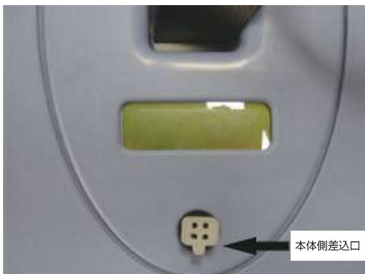
○リフト下側の差込口にハンドスイッチ側の差込口を凹凸を合わせながら深く差し込みます。
