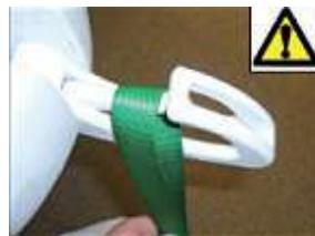
写真3：フックロッククリップに乗りかかったスリングのストラップ
