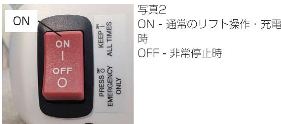
リフトを2分間使用しなければ、リフトの電源は自動に切れます。赤い非常停止ボタンは、ON/OFFスイッチとして使用しないでください。これは、緊急の場合のみ使用します。
