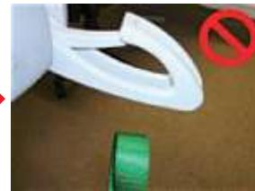
写真5：ハンガーのストラップから外れたスリング
