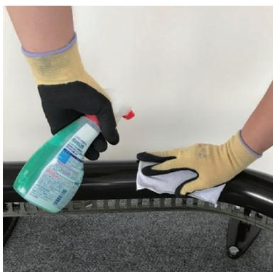
手順①②後、昇降機を動かすと、昇降機側の汚れがレールに付く場合があります。その場合、昇降機を何度か動かし、その度にレールに付いた汚れを落としてください。
