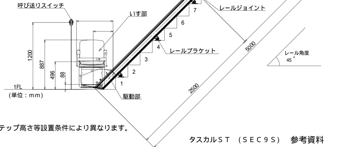
寸法は階段の形状、角度、ステップ高さ等設置条件により異なります。
