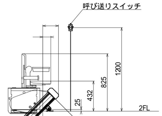
上下階でのレール出寸法 (参考寸法) (単位: mm)
